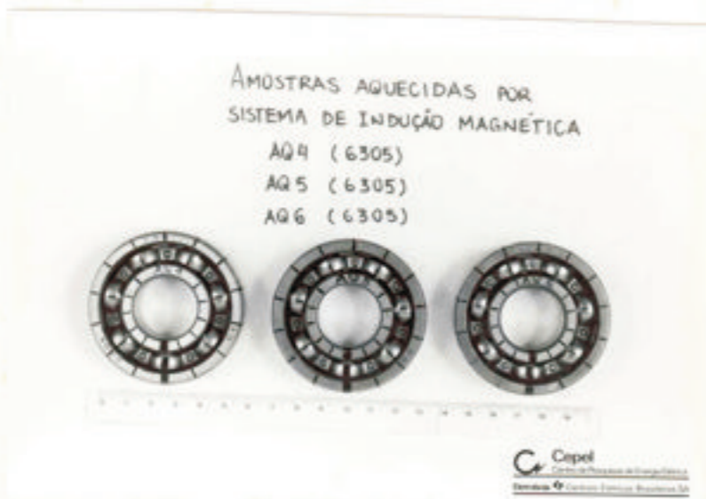
Figura 3 - Amostras aquecidas por sistema de indução eletromagnética, com tempo de desmagnetização igual a três segundos. Foto 821, cartela 25, 19/09/91
