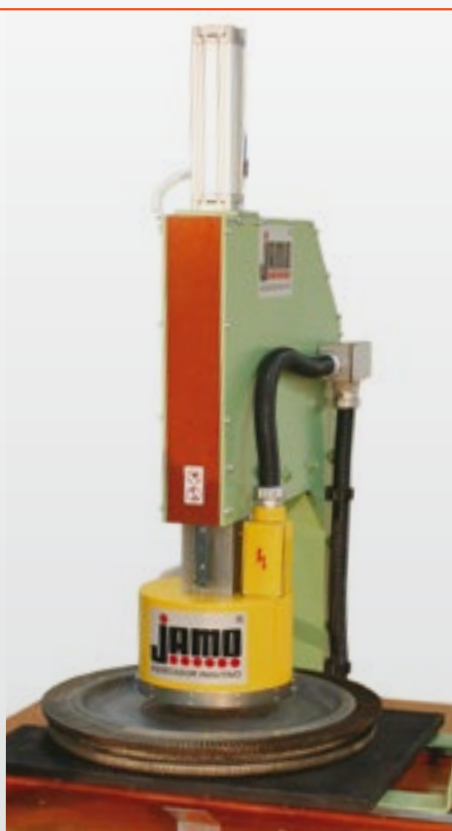
▶ Aquecimento de discos de turbinas
