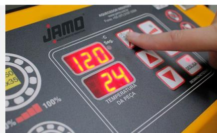
\* O equipamento possui um controlador de temperatura que varia de 0 a 250°C, se achar necessário alterar nas teclas ▼ ou ▲ uma temperatura diferente de 120°C. A máquina armazena em sua memória interna a última temperatura programada.
