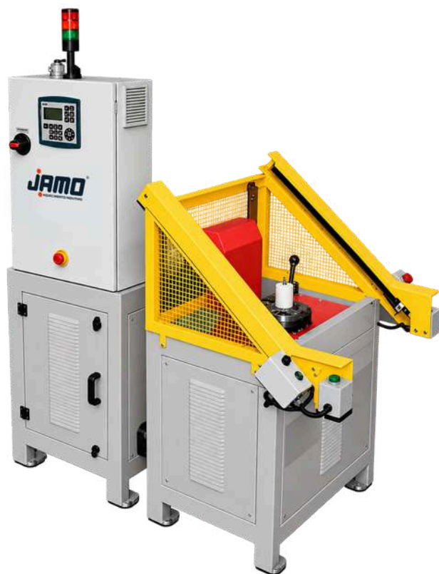
Aquecimento e montagem automática da coroa de diferencial.
