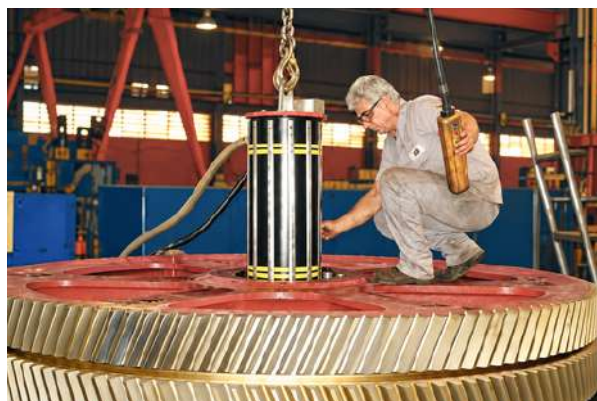
Aquecimento de engrenagens com canhão indutivo.
