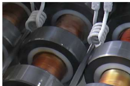
Têmpera e revenimento horizontal, indutor duplo.
