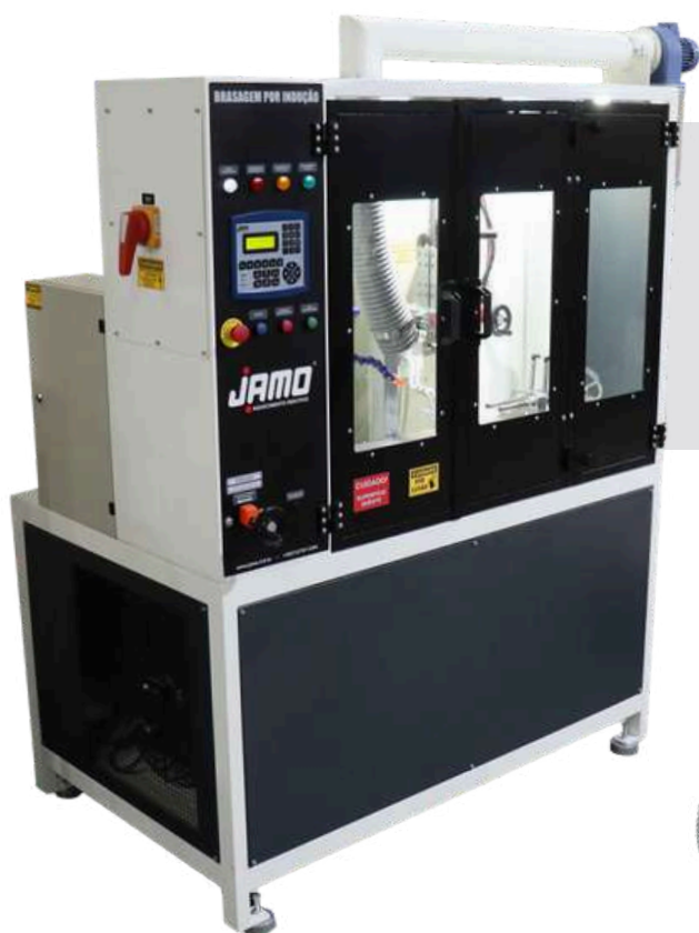
Brasagem de brocas com liga de cobre
