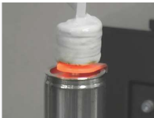
Brasagem de terminais de capacitores.
