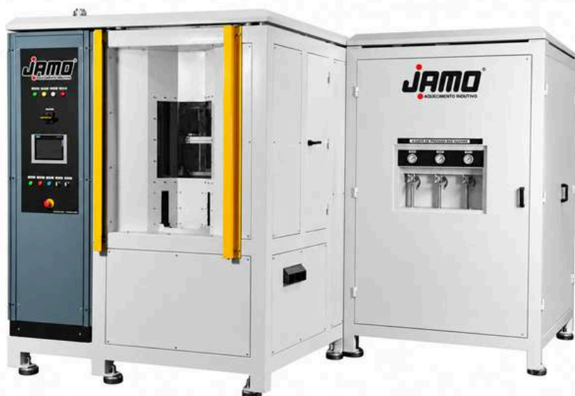
Têmpera e revenimento vertical, indutor triplo.
